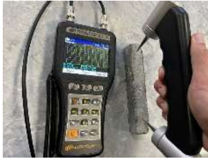
Рис. 1 – УЗ-диагностика орродированного образца
